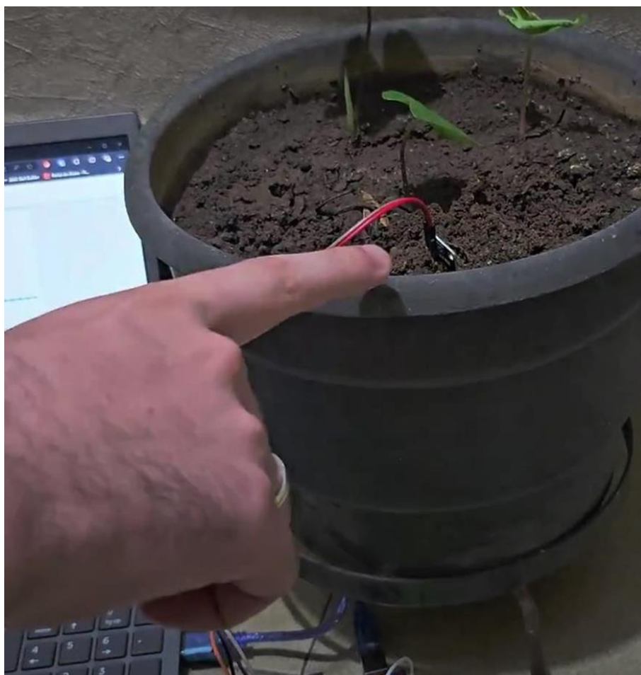
Figura 3 - Sensor de umidade conectado na terra
